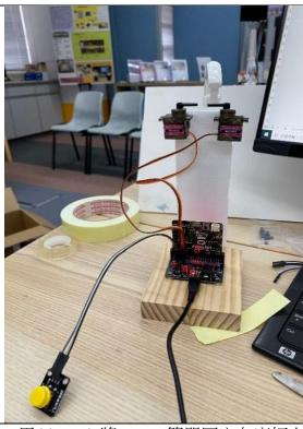
5.用 blu tack 將 IO:Bit 簡單固定在底板上,只要夠放不會鬆動就可以,並將兩個舵機與 IO:Bit 連線之後,用 blu tack 簡單固定在背板的頂端,最後再用幾層封箱膠紙繞圈固定好舵機
