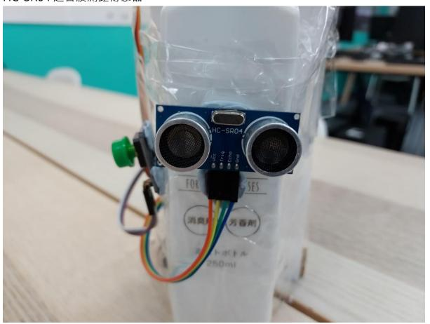
這是 HC-SR04 超音波測距傳感器,今次作為啟動噴手裝置的觸發扳機。本傳感器是透過發送超音波並收回的時候,計算與前方物品的距離,例如我們在前方揮手的時候,本傳感器就會將數字存到 Micro:Bit,然後辨識在一定距離以內的話,就會啟動舵機拉扯噴出消毒液。本次的組裝會將傳感器 黏貼在瓶子上面,並將傳感器與噴嘴對著同一方向,有效距離可以透過調整程式碼來決定,學生們可以自己尋找出最佳的距離
