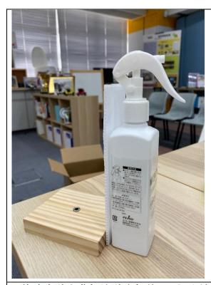
4.將噴壺貼上背板沒貼底板的一面,用封箱 膠紙將背板以及瓶身繞兩個圈固定為一體, 背板是用作設置舵機
