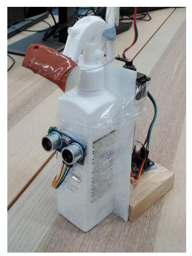
上圖是簡單手製的自動噴手裝置,尺寸小巧,方便製作及移動,也可以有力噴出消毒液,適合作為學生試驗製作的第一步。
