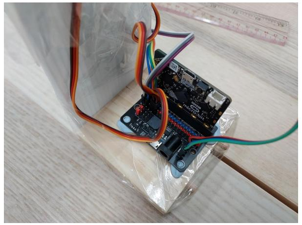
3.首先是整個噴手裝置的核心,IO:Bit 以及 Micro:Bit。有關程式碼之後會再作介紹,首先我們介紹物理的器材,將程式碼輸入 Micro:Bit,以及幫 IO:Bit 接上電源之後,各個器材就會開始運作,而 IO:Bit 上插滿了連繫各個器材的線,現在簡單介紹一下每條線的功用:
